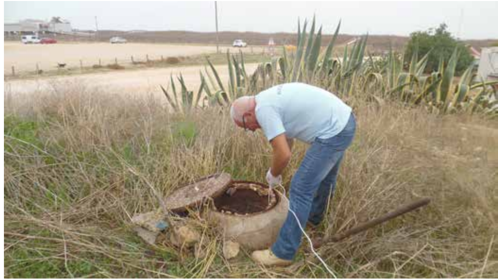
Recolha de uma amostra de água no interior de uma câmara de visita
