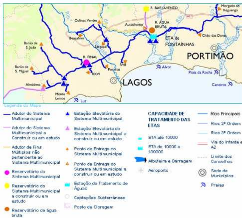
Ilustração 1. Sistema Multimunicipal de Abastecimento de Água Fonte Estudos de Caracterização - PDM de Lagos
