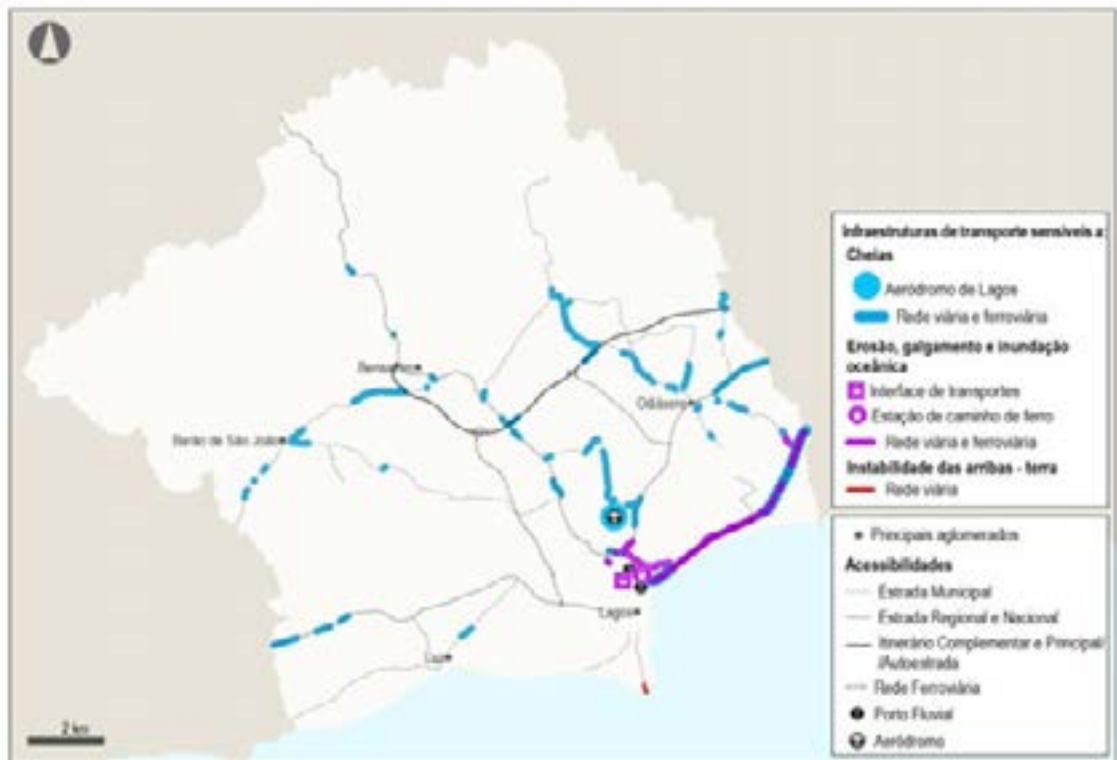
Figura 60. Infraestruturas de transportes sensíveis a cheias, erosão, galgamento e inundação oceânica
