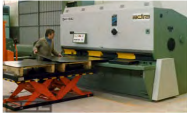
Mesa elevatória - Adaptar a altura do plano de trabalho
