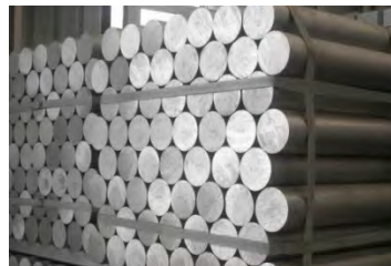
Lingotes de alumínio obtidos por fusão
